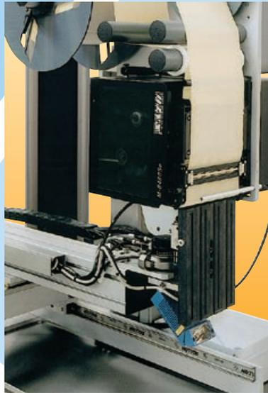
su un sistema di movimentazione a 3 assi, con guide a sfere che permettono un veloce e preciso posizionamento delle etichette anche su pallet di dimensioni, forme e posizioni di arresto leggermente differenti.
