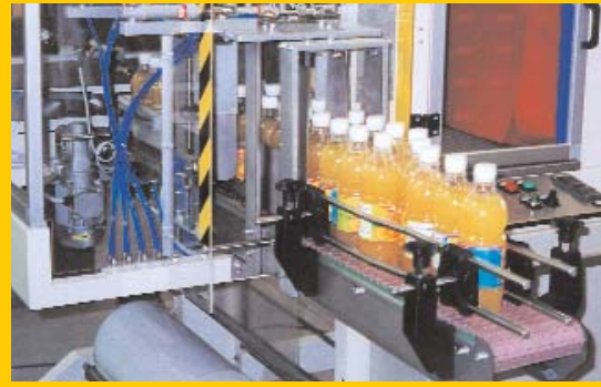
Alimentazione veloce con smistatore su due file, fino a 15 pacchi/minuto, formati 3x2, 4x2, 5x2.
