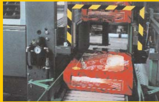
Alimentazioni con gruppo impilatore, per comporre pacchi a più strati.
