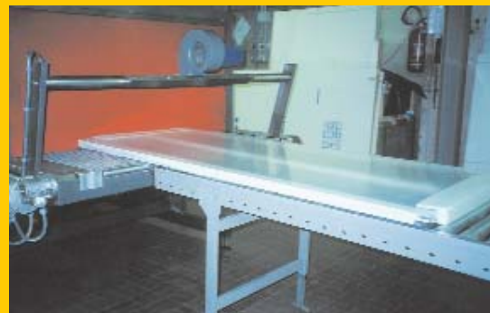
Possibilità di chiusura totale dei lati del pacco, mediante sovrapposizione del film (anche con pacchi di grandi dimensioni).
