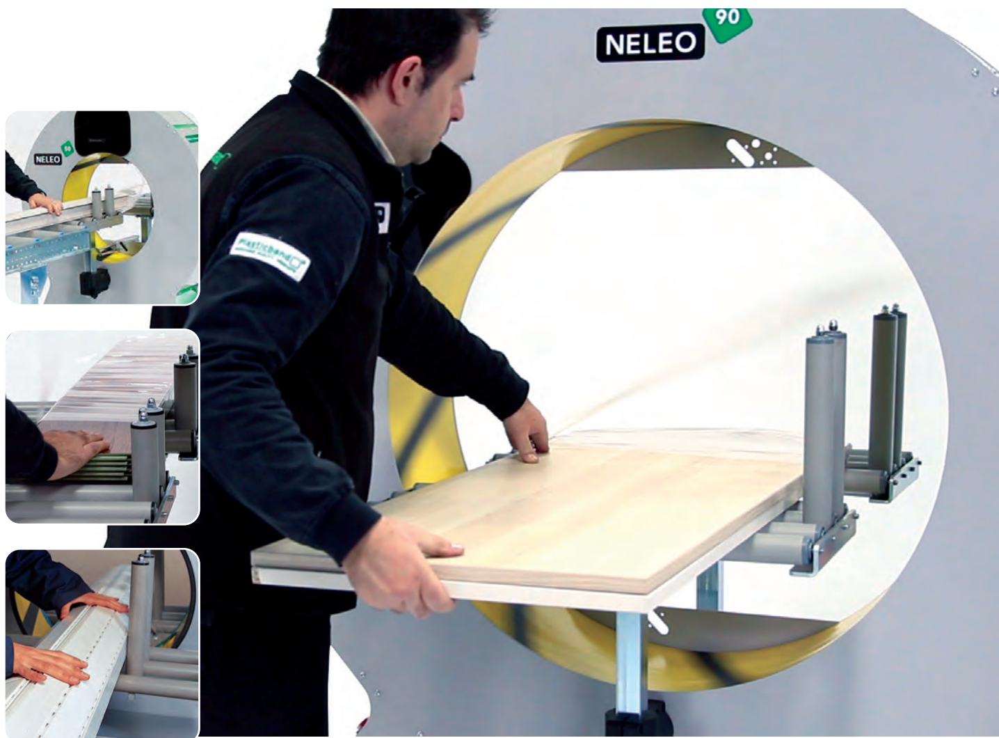
Corte y pinzado automático Automatic film cutter & clamp Coupe et pinceur automatique
