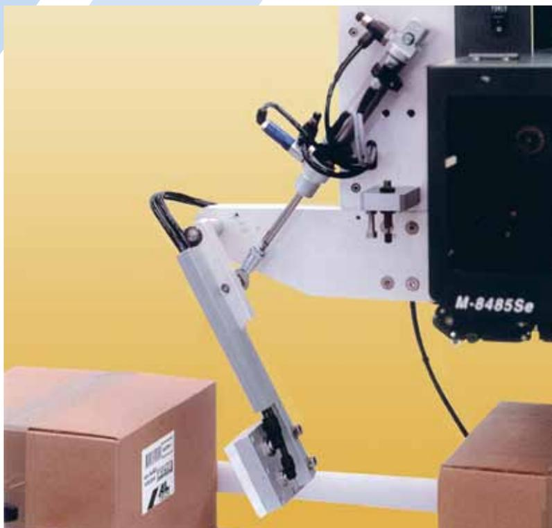
applicatore a braccio rotante per l'etichettatura sul davanti, sul retro e/o ad angolo di prodotti fermi o in movimento.
